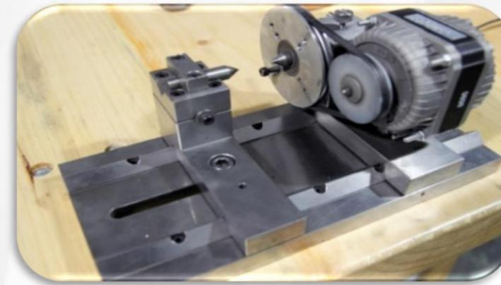
**Dispositivo para peças Cilíndricas Motorizado**
