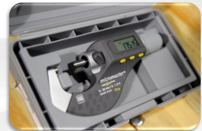
**Micrômetro 0-30mm TESA e outros micrômetros até 300mm**
