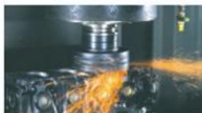
Fresamento de ferro fundido com inserts SUMIBORON
