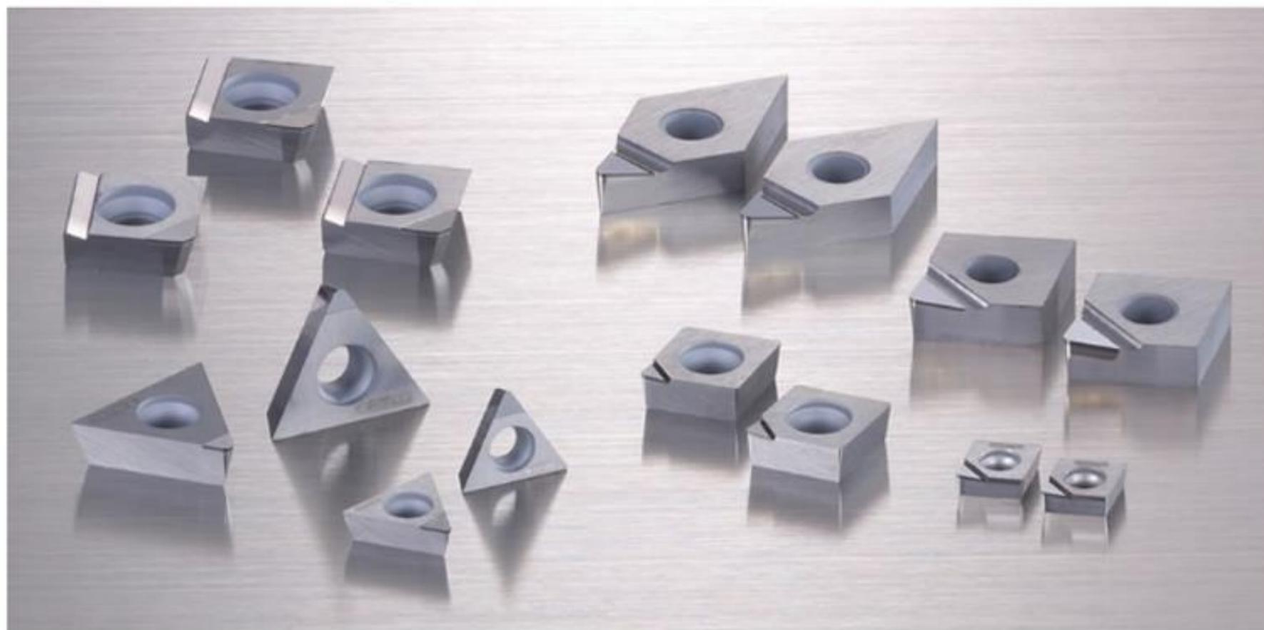
"SUMIBORON" é, essencialmente, CBN (Cubic Boron Nitride, nitreto de boro cúbico), um componente primário ao qual um aglutinante de cerâmica é adicionado e sinterizado sob pressão e temperatura extremas. "SUMIDIA" é um diamante sinterizado compacto de alta densidade com partículas de diamante ultrafinas. □ Ambos os materiais possuem maior dureza e resistência, junto com uma resistência ao calor excelente em comparação com materiais de ferramentas convencionais.
